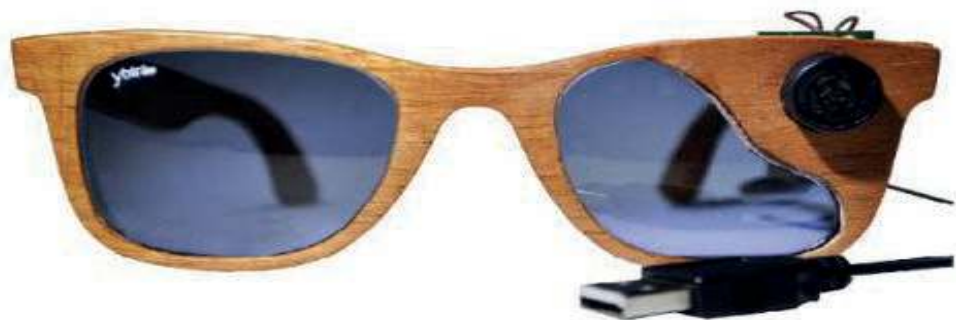
Figura 3: Visão frontal do protótipo com sensor ultrassônico à esquerda.
